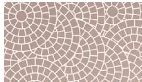
Mosaikpflaster · mosaic laying
