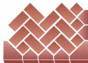
Verlegung mit Bischofsmützen
